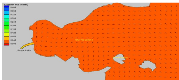
Gambar 4. Model pola arus (kecepatan dan arah arus) pada saat pasang
