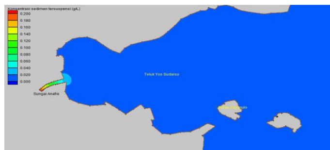
Gambar 5. Model sebaran konsentrasi sedimen tersuspensi untuk simulasi sedimen yang keluar dari Sungai Anafre tersusun atas pasir (Skenario 1) pada kondisi pasang. Warna mengindikasikan konsentrasi sedimen tersuspensi 0,026 g/L hingga 0,200 g/L.
