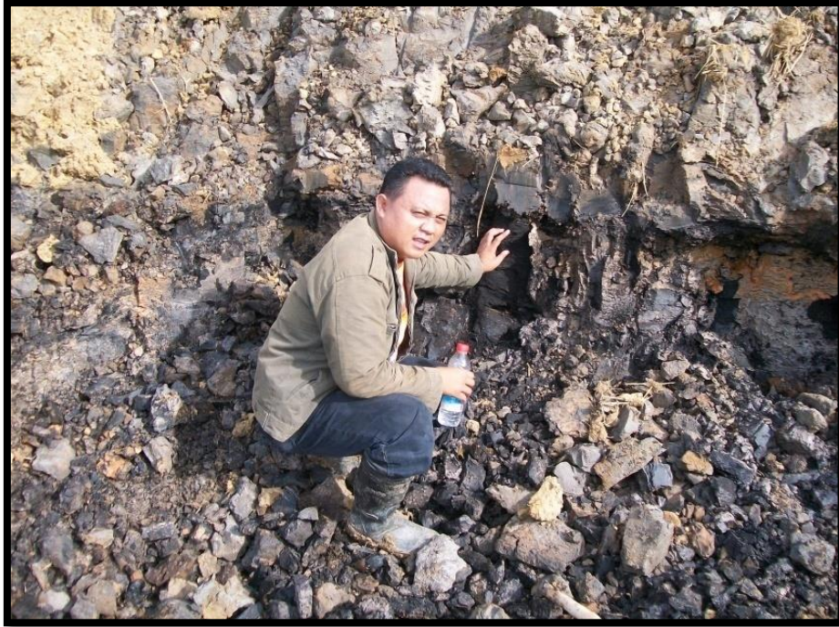
Gambar 2. Singkapan endapan aluvial yang terdiri batubara dengan batuan pengapit batulempung.
