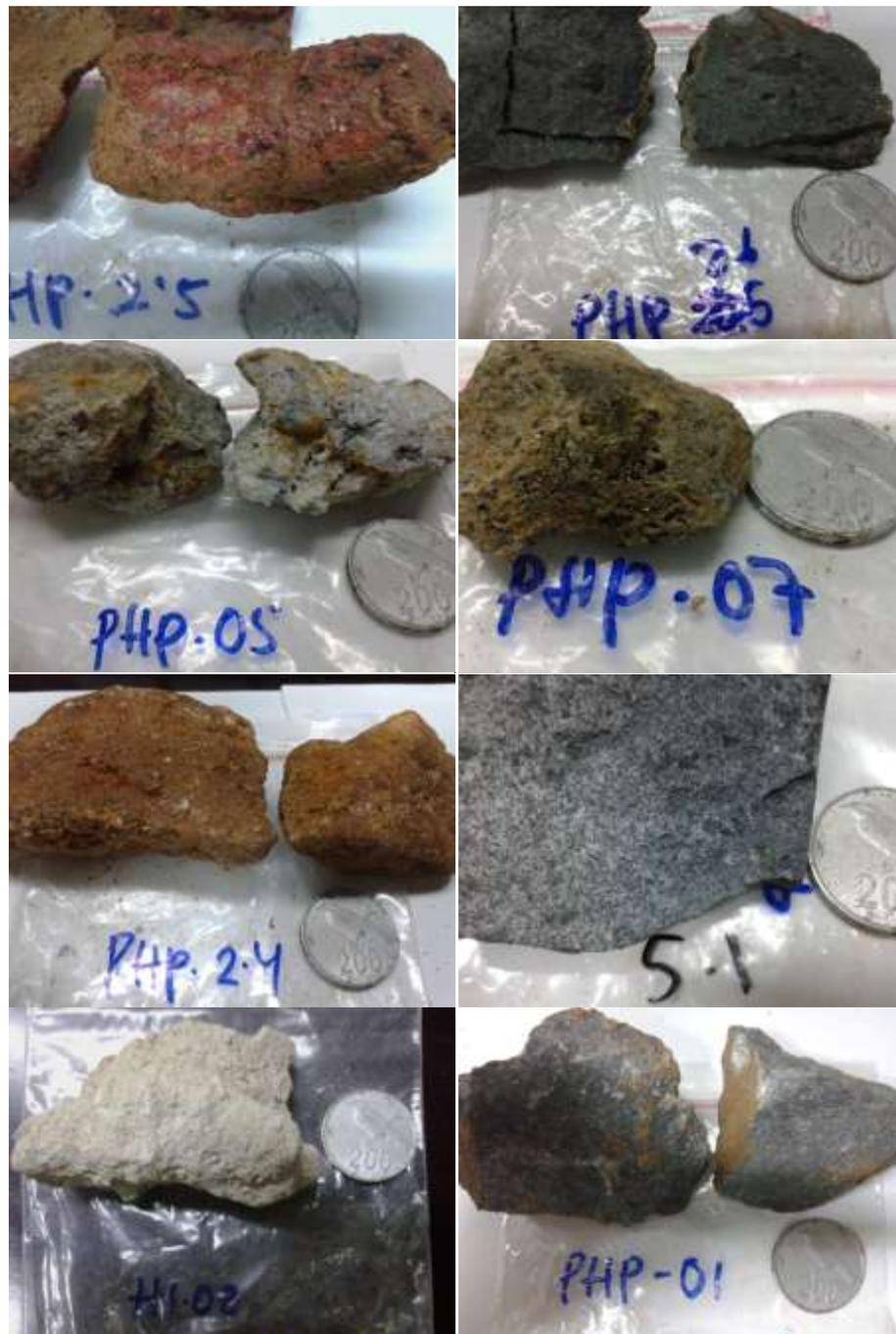
Foto 9 Beberapa contoh batuan yang diambil di lapangan dan siat untuk dipreparasi sayatan tipis dan sayatan poles yang selanjutnya sampel tersebut diamati di bawah mikroskop polarisasi
