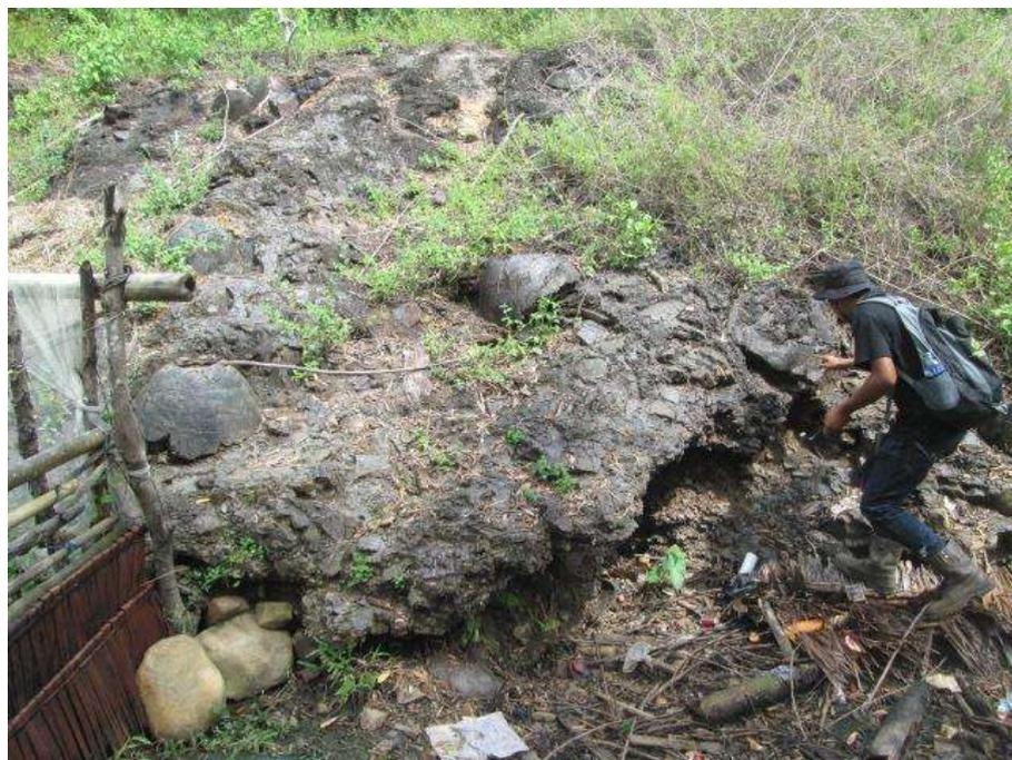
Foto 7 Limbah pengolahan emas di Desa Pasolo hasil peninggalan Belanda yang masih mengandung Fe, Au, Cu, Pb dan unsur lain yang masih bisa dimanfaatkan
