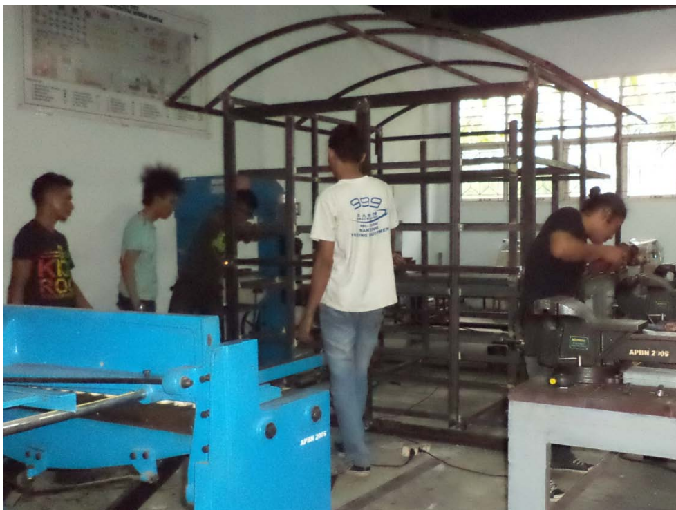
Gambar 2. Pengerjaan Struktur Pengereng ERK di Politeknik Gorontalo
