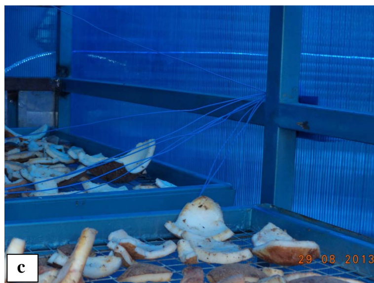
Gambar 10. (a),(b),(c) Pemasangan Kabel Termokopel Ukur
