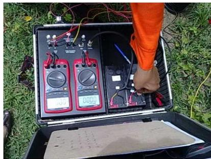
Gambar 7. Alat Geolistrik Untuk Pengukuran Resistivitas Daerah Geotermal
