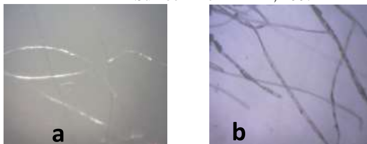
Gambar 7 . (a) serat kapuk sebelum diberi perlakuan dan (b) sesudah diberi perlakuan dilihat pada mikroskop optik dengan perbesaran 200 kali dan cahaya atas bawah.
