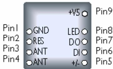
Gambar 2. Pin out dari pembaca RFID
