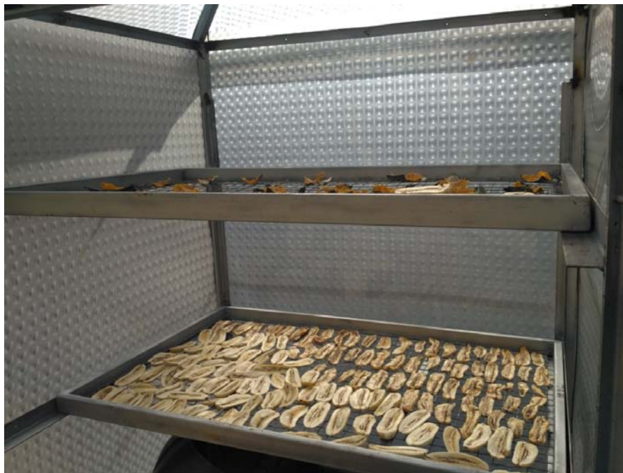
Gambar 9. Pengeringan emping jagung dan pisang pada alat pengering surya.
