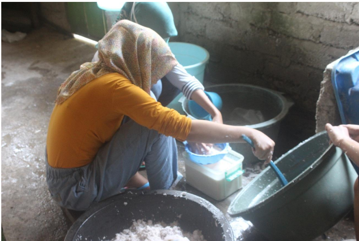
Gambar 6. Proses Pembuatan VCO tahap pemisahan santan kelapa
