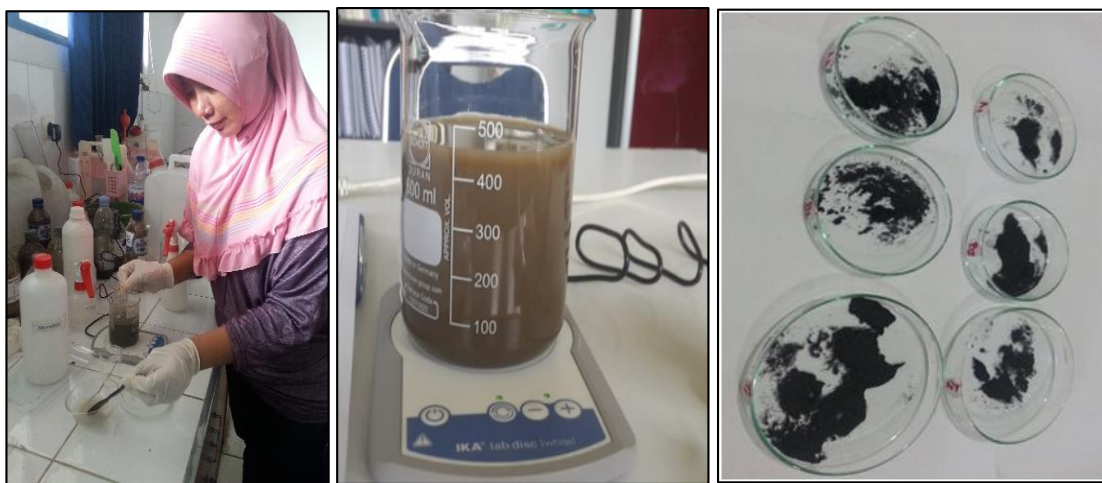
Gambar 4.10 Preparasi ekstrak sampel, (a) proses ekstrak mineral magnetik, (b) alat magnetic stirrer untuk ekstrak mineral magnetik, (c) mineral magnetik yang dihasilkan dari ekstrak.
