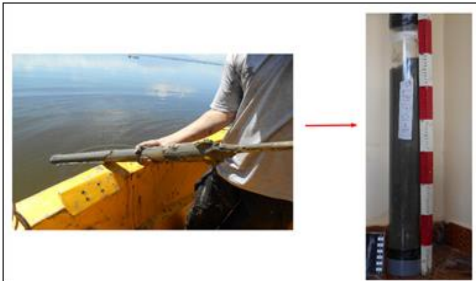
Gambar 4.6 (a) Sampel sedimen core yang berhasil diperoleh dari Danau Limboto, (b) ukuran dan profil sedimen core yang diperoleh.
