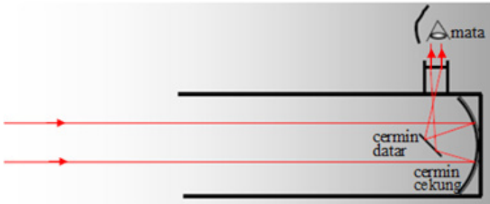
Gambar 20. Pembentukan bayangan pada teropong pantul
