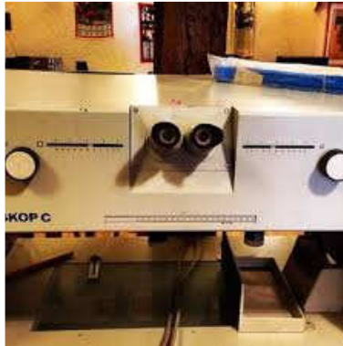
Gambar 14. Interpretoskop C Buatan ZENA
