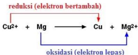
Elektron bertambah ketika  $\text{Cu}^{2+}$  berubah menjadi Cu, sebaliknya elektron berkurang/lepas ketika Mg berubah menjadi  $\text{Mg}^{2+}$ . Jadi  $\text{Cu}^{2+}$  sebagai oksidator, sebaliknya Mg sebagai reduktor.
