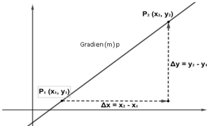
Gambar 2. 3 Ilustrasi Penentuan Gradien
