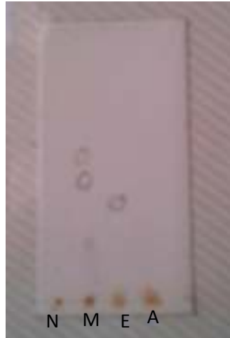
Gambar Hasil KLT fraksi n-heksan (N), ekstrak metanol (M), etil asetat (E) dan fraksi air (A) dengan menggunakan fasa gerak campuran n-heksan: etil asetat dengan perbandingan 8:2
