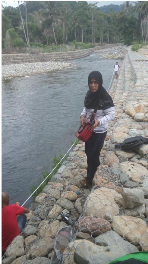
Gambar 10. Pengukuran Kecepatan Air
