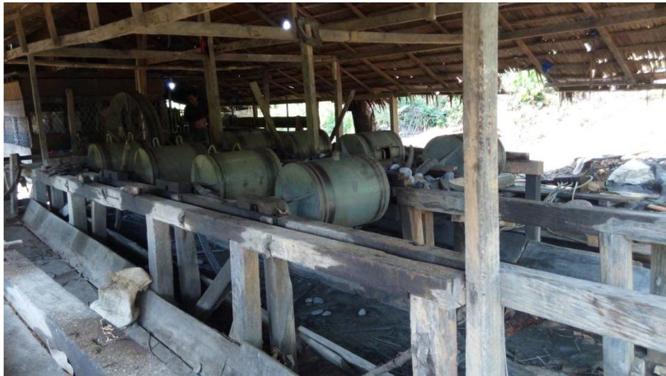
Gambar 1. Kegiatan Pengolahan Emas dengan Menggunakan Tromol
