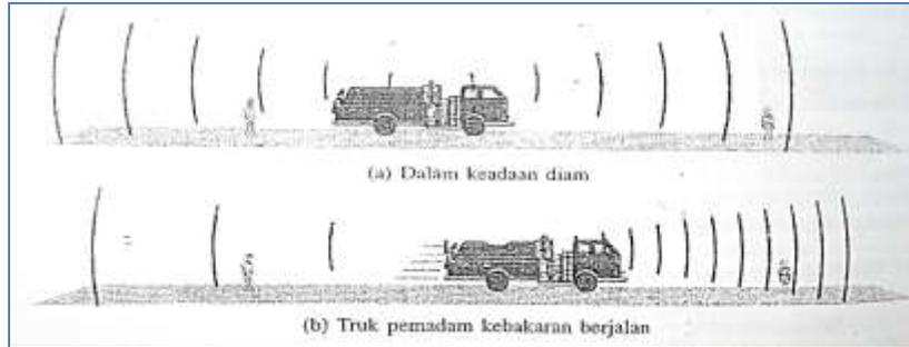
**Gambar 8-1** (a) kedua pengamat mendengarkan frekuensi yang sama dari truk pemadam kebakaran yang diam. (b) saat truk bergerak maju, pengamat yang berada didepan mendengar bunyi dengan frekuensi yang lebih tinggi, dan pengamat dibelakang truk akan mendengar frekuensi yang lebih rendah
