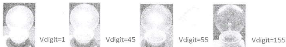
Gambar 5. Intensitas nyala bohlam lampu pada nilai tegangan digital 1, 45, 55 dan 155
