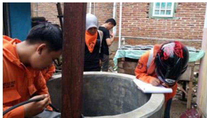
Gambar 2. Pengambilan data lapangan berupa pengamatan parameter fisika air sumur dan pencatatan kedalaman air tanah serta pengambilan sampel untuk analisis parameter kimia
