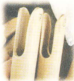
Gambar 1.19 Bambu yang Lidahnya Telah Jadi
