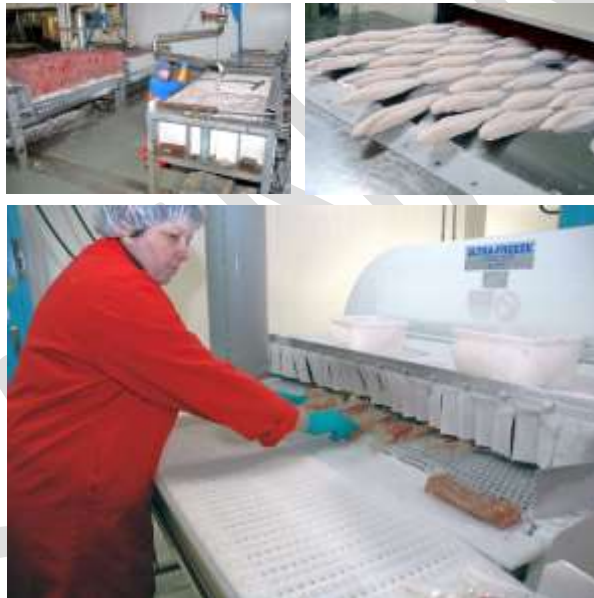
Gambar 17. Contoh pengoperasian contact plate freezing jenis vertical plate freezers (VPF) (Kiri atas), pembekuan jenis fillets ikan yang akan membeku ketika dilewatkan pada saluran mesin air blast freezers (Kanan atas), Pembekuan Cryogenic Freezing menggunakan nitrogen cair atau karbon dioksida sangat cepat tetapi biayanya lebih tinggi (Bawah). (Sumber: http://www.eurofishmagazine.com/ )
