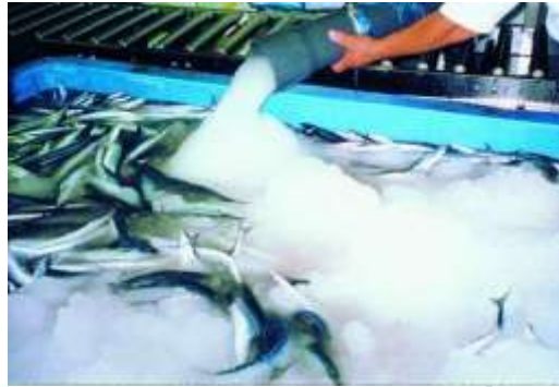
Gambar 15. Penerapan es slurry untuk pendinginan ikan
