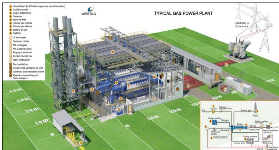
**Gambar 6.** Ilustrasi desain bangunan PLTMG Luwuk (40 MW)
