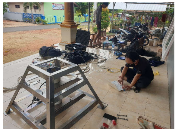
Melakukan pengaturan deployment pada ADCP
