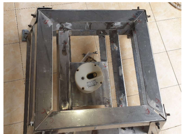
Modul baterai ADCP tampak atas didalam Frame
