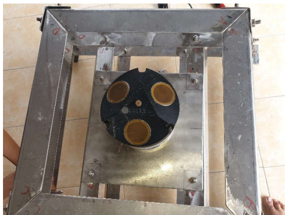
ADCP tampak atas dengan 3 sensor velocity
