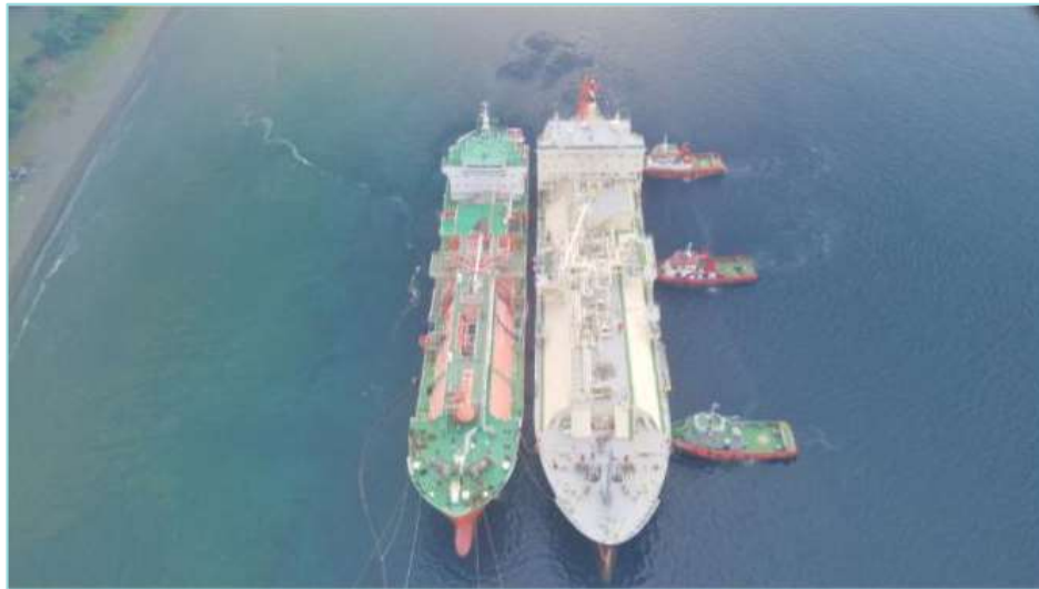
Gambar 5. Proses bongkar muat LNG dari LNGC ke Temporary FSRU
