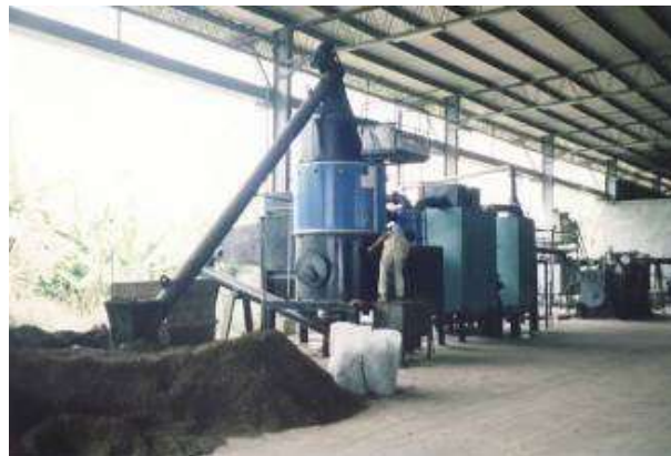
Gambar 6. Teknologi gasifikasi dan Unit Gas Engine kapasitas 200 KW Pembangunan Malaysia Tahun 2001
