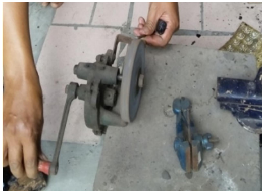
Gambar 5. Membentuk paku baja untuk dijadikan alat tatah dalam membuat atribut busana pengantin (Foto: Hariana, 29 Juni 2016 di Yogyakarta)
