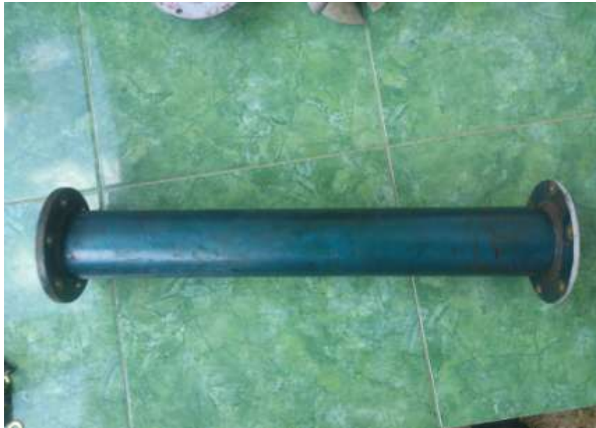
Gambar 8. Rumah batang as dan turbin
