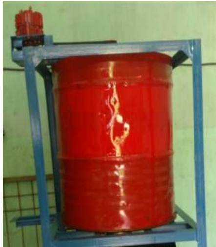
Gambar 2. Rancangan pembangkit listrik tenaga pikohidro
