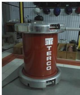
*Gambar 3. 1 Transformator penaik tegangan 100 kV*
