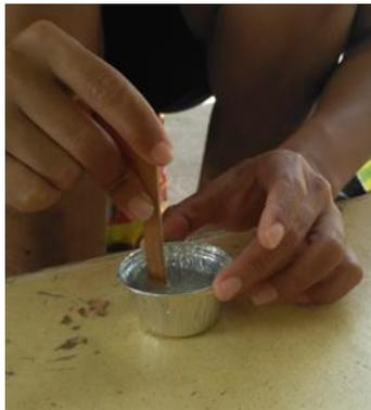
*Gambar 3. 26 Proses pencampuran clear epoxy resin dan clear epoxy resin hardener*
