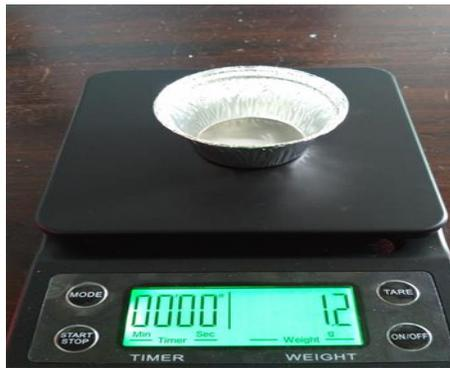
*Gambar 3. 22 Kalibrasi timbangan dengan wadah*
