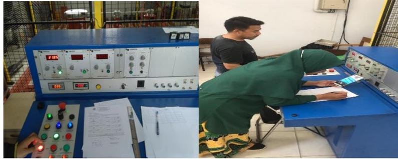
*Gambar 3. 32 Proses pengujian tegangan tembus*
