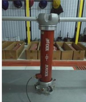
*Gambar 3. 2 Kapasitor tegangan tinggi*
