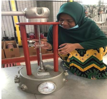
*Gambar 3. 31 Pemasangan bahan uji pada elektroda jarum – jarum*
