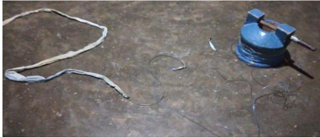
*Gambar 136. Kontruksi pancing tonda dengan sutas kain untuk menggerakkan umpan.*
