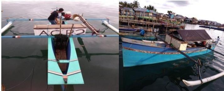
Gambar 163. Perahu ketinting yang digunakan nelayan suku Bajo.
