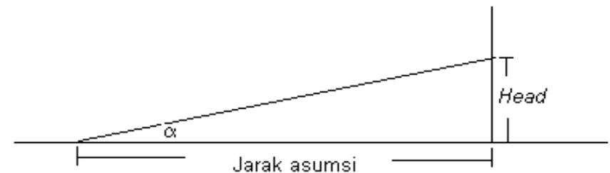
Gambar 7.4, Penentuan *Head* berdasarkan asumsi jarak ideal dari titik pengamatan sampai ke bangunan PLTMH
