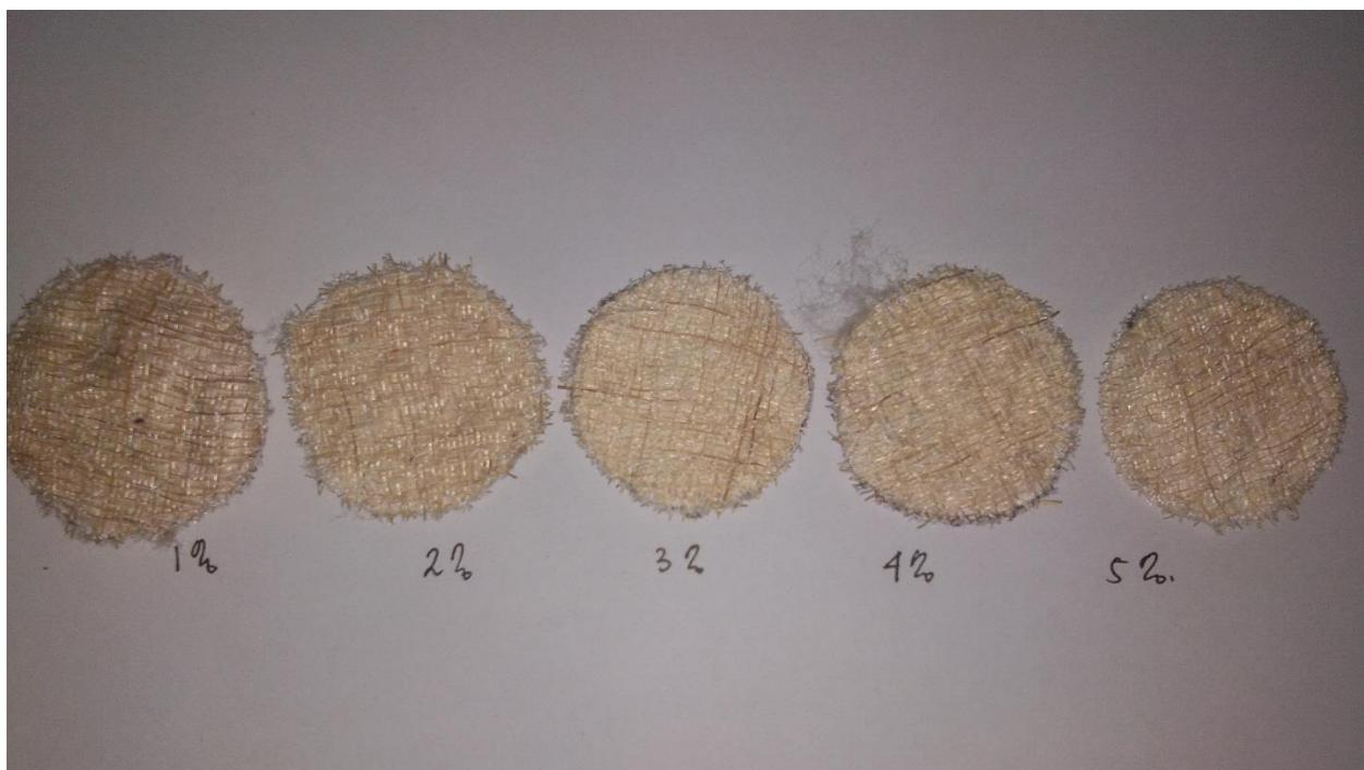
Gambar 20 Lembaran Komposit Serat Kapuk-Sabut kelapa-serat sintesis
