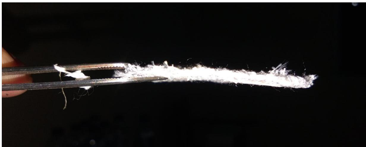
Gambar 19 Serat Kapok-serat sintesis tampak depan dan samping (Kapok treated NaClO 3%)
