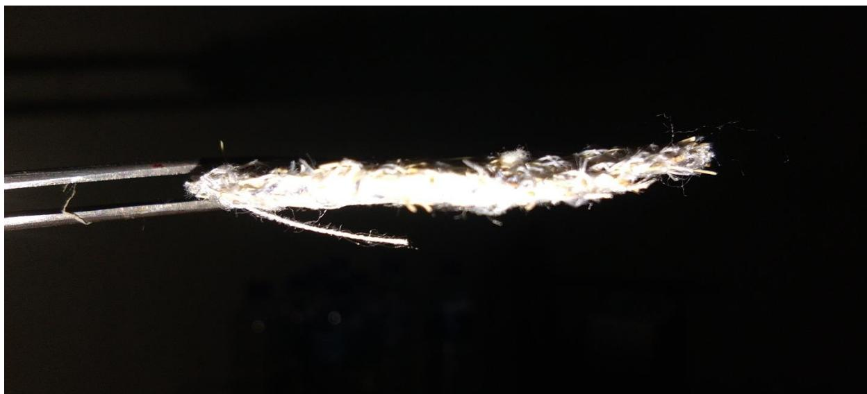
Gambar 21 Serat Kapok-Sabut kelapa-serat sintesis tampak depan dan samping (Kapok treated  $NaClO$  3%)
