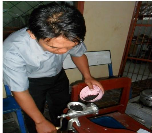
**Gambar 6. Proses pencetakan biopellet**
