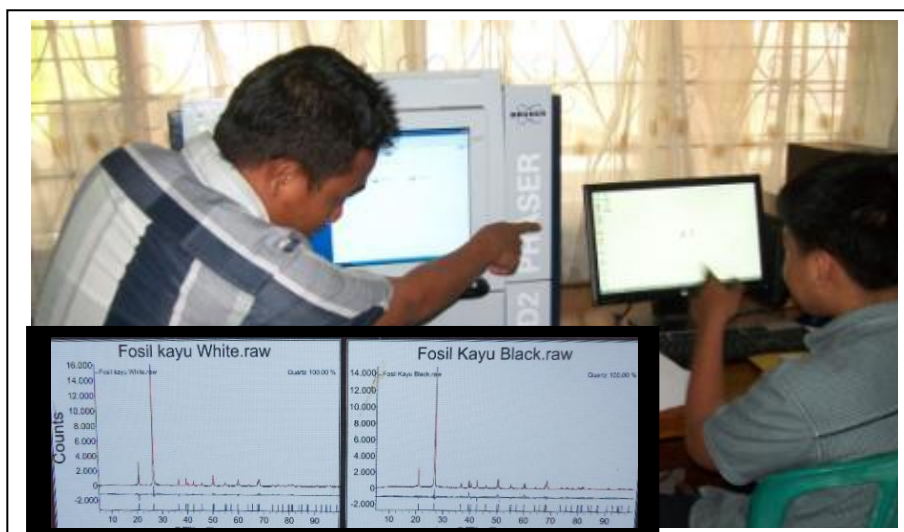
Gambar 6. Analisa X-Ray Diffraction (XRD) di Laboratorium Fisika, (inzert : Grafik Dikfragtogram menunjukkan mineral penyusun fosil kayu 100% Quartz (Kuarsa))
