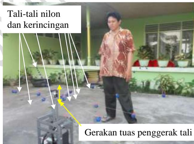
Gambar 22. Pengujian Alat Pengendali Hama
