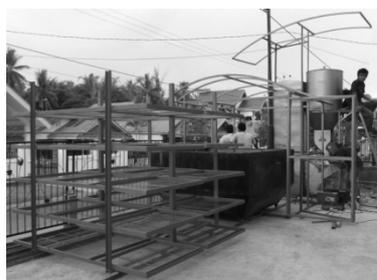
Gambar 2. Instalasi unit sistem pengeringan dengan kerangka dan rak pengeringan bahan
