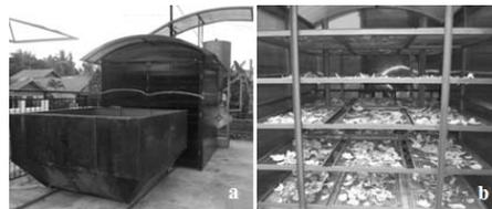
Gambar 5. Sistem pengeringan siap uji (a), model rak dalam pengering (b).
