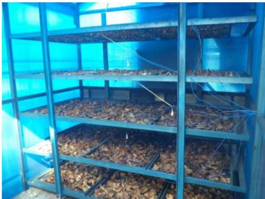
Gambar 9. Pengukuran titik suhu dengan termokopel kabel
