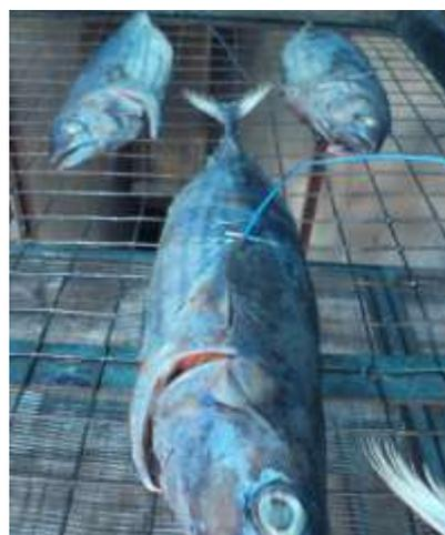
Gambar 20. Pemantauan suhu dalam daging ikan melalui ujung termokopel.
