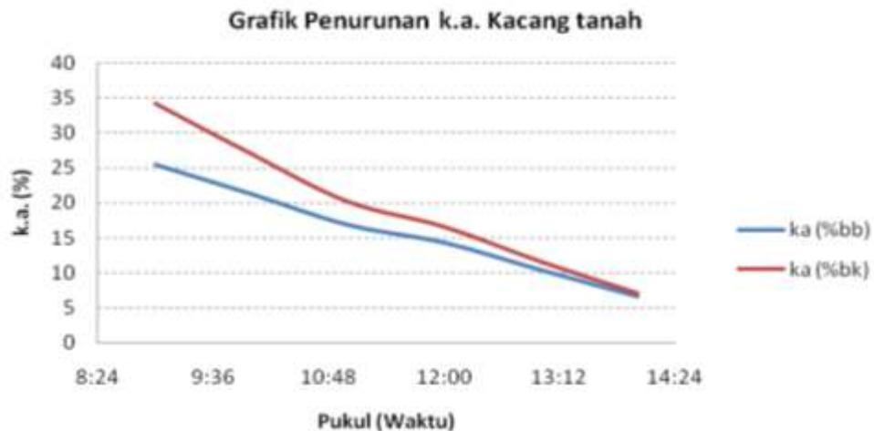
Gambar 32. Grafik penurunan kadar air kacang tanah
