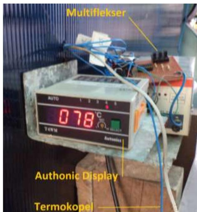
Gambar 4. Termokopel kabel tipe K, Display dan Multiflekser
