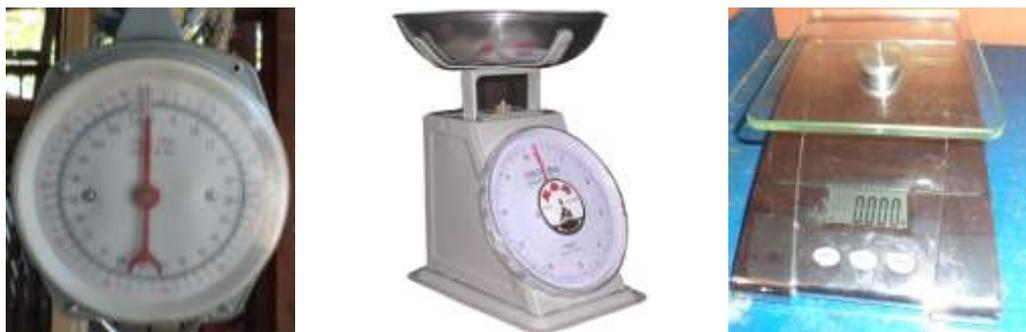
Gambar 2. Jenis timbangan; analog gantung (a), analog duduk (b), digital (c)
