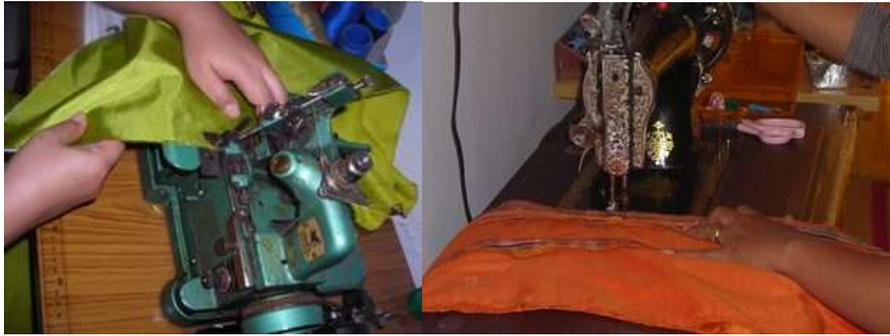
Gambar 94. Proses Penjahitan dengan menggunakan mesin low speed
