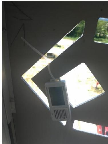
Gambar 4.3 Lokasi alat ukur digantung di lubang panel
