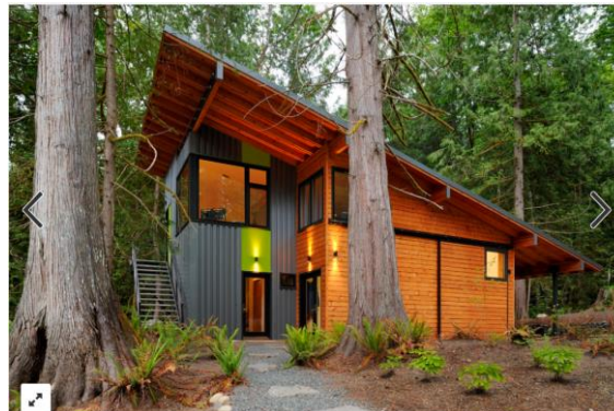
Gambar 2.3 Bentuk atap shed
