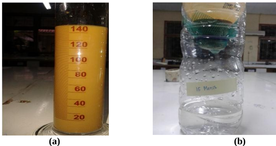
Gambar 14 Keadaan air limbah pertambangan sebelum (a) dan sesudah (b) disaring dengan serat kapok.
