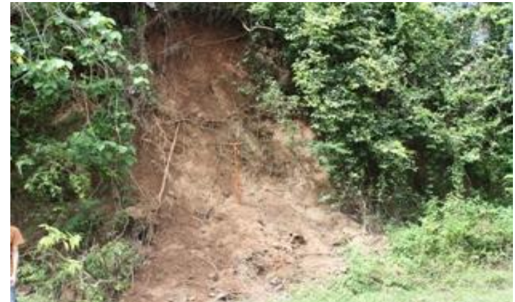
Gambar 3b. Planar Slide di Desa Labanu Kec. Tibawa Kab. Gorontalo
