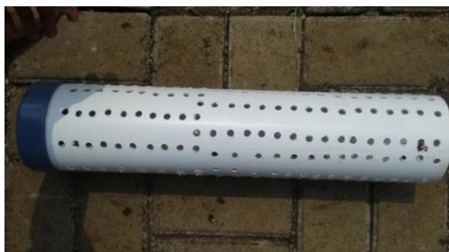
Gambar 2. PVC yang dilubangi
