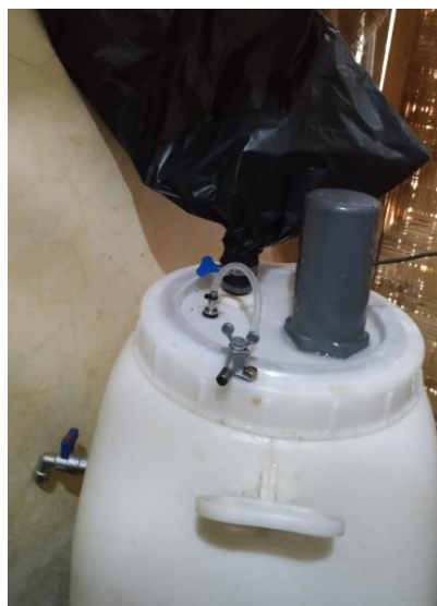
Gambar 9 digester sederhana untuk menghasilkan gas metan dari sampah organik
