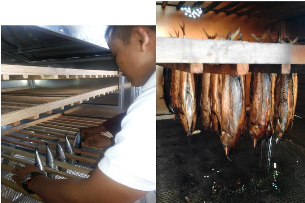
Gambar 1. Alat Pengasapan Model Kabinet
