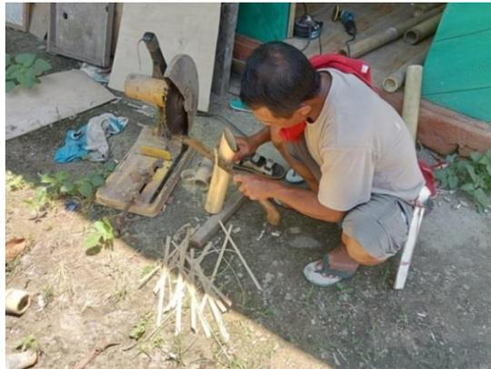
Gambar 5.5 Proses Mengupas Permukaan Luar Bambu
