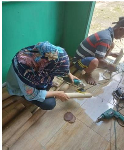
Gambar 5.6 Proses Meratakan Permukaan Bambu Menggunakan Mesin Amplas
