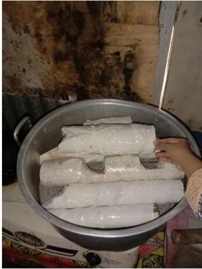
Gambar 5.9 Proses Tranfer Warna Dengan Cara Dikukus
