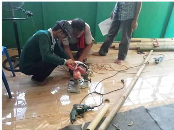
Gambar 5.4 Proses Memotong Bambu Menggunakan Mesin Gergaji
