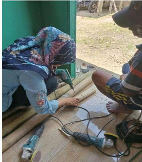
Gambar 5.7 Proses Melubangi Bagian Bambu Menggunakan Mesin Bor
