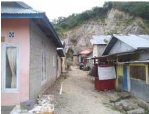
Gambar 3.31 Area Tanpa Sistem Drainase (Sumber: Penulis 2024)
