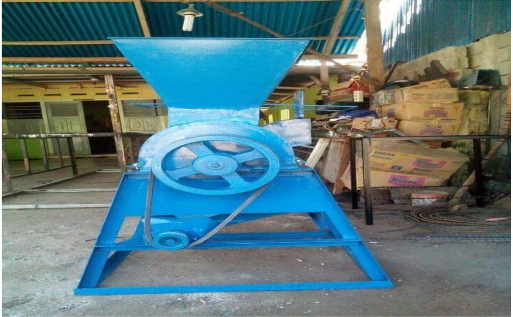
Gambar 8. Produk TTG Mesin Pengepil Jagung
