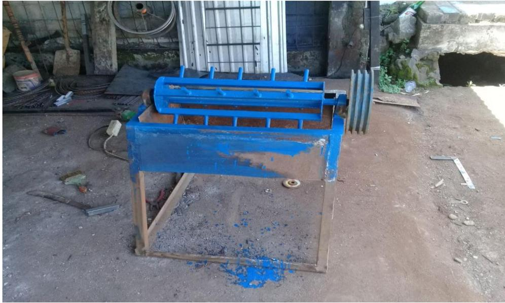
Gambar 6. Proses Pembuatan Mesin Pengepil Jagung tahap 1
