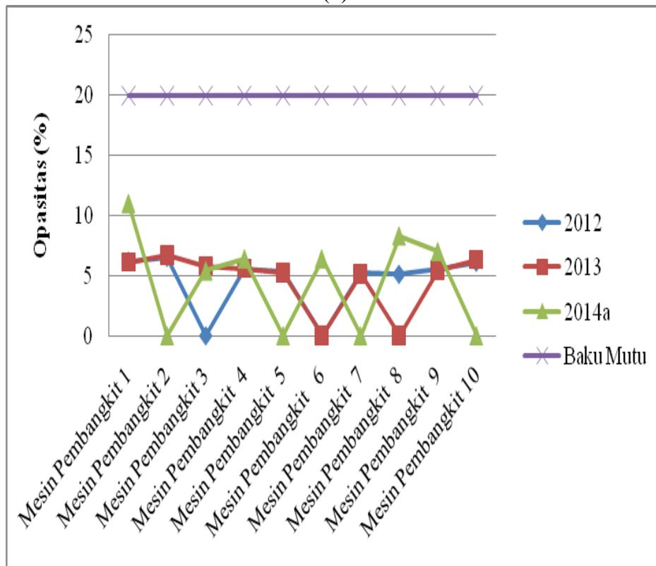
Gambar 2.4 Trend Hasil Pengukuran Emisi Gas dari Cerobong di PLTD Telaga
